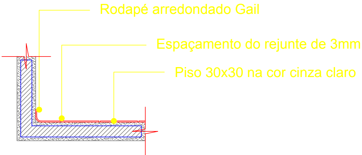
DETALHE 01 - RODAPÉ ESC: 1/25
